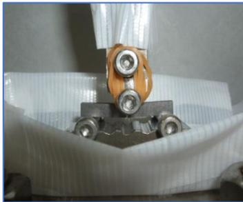
③ 核融合炉用プラズマ対向材料の機械的特性及び微細組織に及ぼす中性子照射効果の評価 (タングステン、黒鉛及びC/C複合材等の特性と組織に及ぼす中性子照射効果の究明) : 高性能を有するプラズマ対向機器の開発研究を目標に、中性子照射材料の機械的性質及び微細組織の究明を行っている。図③は、ホットラボ内で、試験片飛散を防止しながらの曲げ試験状況を示す。
