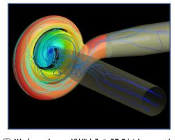
②汚水用ポンプは異物を含む液体輸送に用いられるため、羽根枚数を一枚とした特殊な羽根車が使用されている.しかし、羽根車の非対称性に基づく変動流体力が作用し、効率も低い.本研究では、変動流体力および損失生成機構を解明し、汚水用ポンプの高性能・高信頼性化を目指している.
