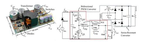
究室では複数台コンバータの一体化が可能なマルチポートコンバータを開発しています。マルチポートコンバータは幾つかの汎用コンバータにおいて類似の回路部分を共有させることで導出することができます。回路を共有させつつ複数のコンバータを一体化できるため部品点数のみならずコンバータの台数も削減可能なため、従来システムと比較して飛躍的な簡素化ならびに低コスト化を実現できる可能性を秘めています。
