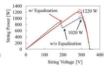
抽出可能電力が大幅に低下することが知られています。研究室では、部分影の悪影響を防止可能な電力変換器である「部分影補償器」の研究を行っています。部分影補償器を用いることで影の掛かっていない太陽電池モジュールから部分影の発生している太陽電池モジュールへと電力伝送を行い、疑似的に全ての太陽電池モジュールの特性を均一化することができます。
