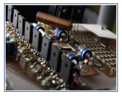
②上記の水処理にはメガワット級の瞬時大電力が必要です。これを可能にするのは SiC・GaN といった次世代パワーデバイスです。これらは応答時間がナノ秒域と短いため、電力損失を起こしやすい水の表面での放電に適しています。一般家庭の排水であれば数平米のソーラーパネルで電力をまかなえる電力変換効率が得られています。高効率化や長寿命化のための回路方式について検討を続けています。
