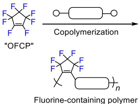
② 含フッ素高分子は耐熱性、撥水性などの特徴的な性質を示すため、フライパン、撥水ガラスのコーティング剤、Oリングなどのシール材など様々な製品に利用されています。含フッ素高分子の合成は多段階を要するだけでなく、それらの原料であるフッ素化合物の多くは扱いづらいなどの問題があります。私たちは含フッ素高分子の出発原料として反応性の高い環状フッ素化合物（ペルフルオロアルケン）に着目し、入手かつ取り扱い容易なペルフルオロアルケンを原料とする効率的な含フッ素高分子材料の合成法の開発を行っています。最近では光学材料として有望な高透明かつ低屈折率含フッ素高分子材料の創製を目指しています。
