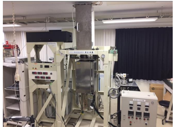
図1 るつぼ回転粘度測定装置
