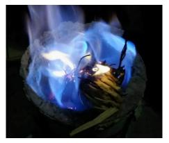
②たたら製鉄は、砂鉄と木炭を原料とした日本固有の製鉄方法です。たたら製鉄では、砂鉄を木炭の燃焼によって低温還元精錬することで「玉鋼」と呼ばれる日本刀の原料が作り出されます。しかし、この「玉鋼」の精錬メカニズムについては、詳しく解明されていません。ズムの解明を目的とした研究を行っています。さらに、この研究によって得られた知見を他の金属の精錬応用することを目指して研究を進めています。
