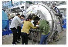
②J-PARC ミューオンビームを蓄積するために、 サブ ppm レベルの均一度で調整された磁場を実 現する蓄積磁石の設計製作に取り組んでいま す。これは、医療用 MRI の設計技術を応用した 手法を用いています。私たちはテストベンチで 磁場均一調整技術を実践的に学んでいます。 In order to accumulate the J-PARC muon beam, we are working on the design and fabrication of a
