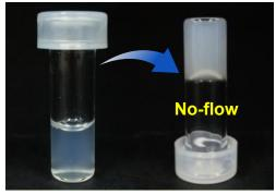
②ポリマー材料の高機能化を目指して、ナノ複合材料の開発をおこなっています。例えば、温度応答性ポリマーの水溶液に対して、微量のナノクレイをナノ複合化することで、含水率95%以上でも、温度上昇に伴い固化する材料が得られています。
