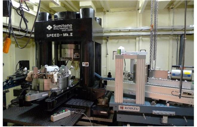
② 地球内部の地震波速度構造は、地球内部の化学組成や物性を明らかにするうえで最も重要な鍵である。一方、高圧鉱物の弾性定数はこうした地震波速度速度構造を解釈する上で不可欠な情報です。私は大型プレスと超音波測定装置を用いて地球の下部マントルに相当する高圧高温下での弾性波速度の精密速度測定法を開発しています。
