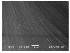
②合成した側鎖にアミノ基を有するポリアミド酸溶液に、トリエトキシシリルプロピルクエン酸とテトラエトキシシランと水を加えてゾルーゲル反応して、ガラス板上にキャスト後、熱イミド化してシリカとポリイミドが化学結合で結ばれた複合材料を作製した。そのフィルムは相分離することなく強靭でであった。
