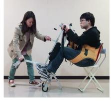
②超小型・軽量な折りたたみ式の新しい移乗器を開発した. 本機器を折りたたんで車いす後部に携帯しておけば、外出先でも利用できる. また、その横幅はわずか36cmなので、障がい者用トイレのみならず、一般トイレでも利用できる. 移乗時に必要な力はとても小さく、小柄な女性でも簡単に移乗動作が可能である.
