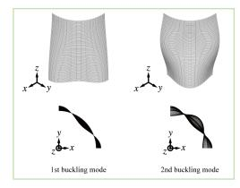
②薄肉構造の設計において、座屈や分岐など不安定現象を回避することは重要であり、それらを精度良く予測する技術が必要になります。本研究室では、3次元の力のつりあい式を考慮できるシェル要素と剛性行列の固有値に着目した分岐点探索アルゴリズムを組み合わせて、シェル構造の不安定現象を予測・評価する技術を研究しています。 In the design of thin-walled structures, the techniques to accurately predict the
