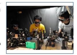
②非線形偏波回転効果を用いた受動モード同期ファイバレーザを開発しています。発振波長1550 nmのEr:ファイバレーザでは、パルス幅303 fs、平均出力パワー3.39 mW、繰り返し周波数29.9 MHzが得られました。これを自作のEr添加ファイバ増幅器(EDFA)で増幅し、平均パワー23.7 mW、ピークパワー2.26 kWが得られ、これを50 mの高非線形分散シフトファイバに通したところ、スペクトル幅700 nmのスーパーコンティニウム光が得られました。
