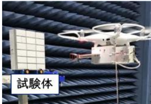
インフラ検査用のドローン搭載 型ミリ波センシングシステム
