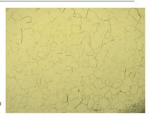
②アルミニウム材の耐食性改善のためにTiを添加した。腐食形態が深さ方向から面方向に変化した。断面組織をEPMAで観察すると層状にTiが析出していることが判った。
