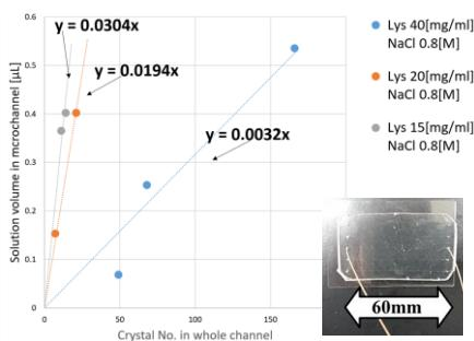
②中性子回折法はX線解析等より信頼性の高い水素位置情報が取得できるが、強度が弱いため試料結晶を大形化しなければならない。合理的な結晶化方法の開発を、微小流路環境を用いて開発している(左図; 特開2022-087076JP)。
