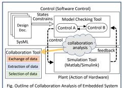
② 組込みシステムの開発では、制御ソフトウェアと制御対象(プラント)がどのように影響を及ぼし合うかが設計の主要な関心事になる. しかし、これらは性質が大きく異なることから、ひとつの枠組みで表現し解析することが難しい. 本研究では、各々の特徴を活かした設計情報を組み合わせる協調解析手法を探求している.
